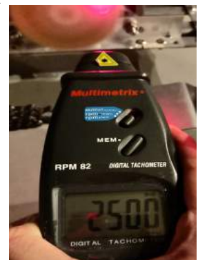
rotor alimenté en 4S sur le moteur de 110A
